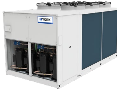
YHA Luft-Wasser WP 4-Leiter System Scroll Verdichter / R410A Warmwasser bis zu 60°C Heizleistung: 22 bis 464 kW Heizbetrieb bei Umgebungstemp. bis -20°C
