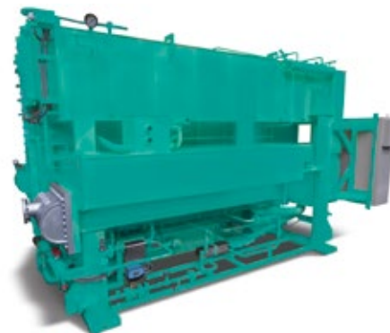
YHAP Absorptionswärmepumpe Dampf, Gas oder Heißwasser-Antrieb / R718 Warmwasser bis zu 95°C Heizleistung: 900 bis 40000kW
