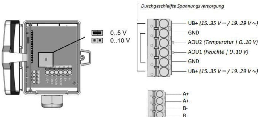
Abbildung 7: Anschluss SHT-130B-UDx
