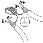
Bei durchgeschleifter RS485 Verkabelung beide Kabelschirme mittels der beiliegenden 2-pol. Klemme wie dargestellt verbinden.
