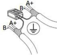
Bei durchgeschleifter RS485 Verkabelung beide Kabelschirme mittels der beiliegenden 2-pol. Klemme wie dargestellt verbinden.
