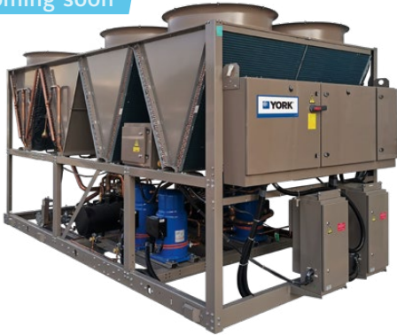
YCPB Luft-Wasser WP 2 oder 4-Leiter System EVI Scroll Verdichter / R454B Warmwasser bis zu 60°C Heizleistung: 280 - 460 kW
