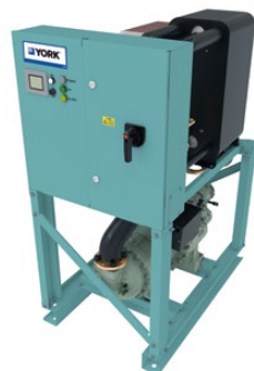
YCSE Wasser-Wasser-WP Schrauben-Verdichter / R513A Warmwasser bis zu 57°C Heizleistung: 170 bis 300 kW Bis zu 8 Module in einem Wassersystem
