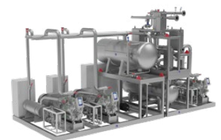
HyePAC Wasser-Wasser-WP Ammoniak-Wärmepumpe + Wasser (R718) mit Hubkolbenverdichter und drehzahlgeregeltem Antrieb Warmwasser bis zu 120°C Heizleistung: 300 bis 2000kW
