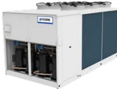
YHA Luft-Wasser WP 4-Leiter System Scroll Verdichter / R410A & R454B Warmwasser bis zu 60°C Heizleistung: 22 bis 464 kW Heizbetrieb bei Umgebungstemp. bis -20°C
