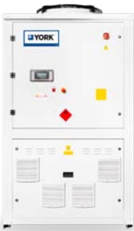
YAS/Rc-WP Luft-Wasser WP Kolben Verdichter / R290 Warmwasser bis zu 55°C Heizleistung: 103 bis 333 kW Heizbetrieb bei Umgebungstemperatur bis -15°C
