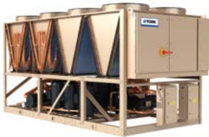
YLPB Luft-Wasser WP Scroll Verdichter / R410A Warmwasser bis zu 55°C Heizleistung: 344 bis 653 kW Option Enthitzer verfügbar
