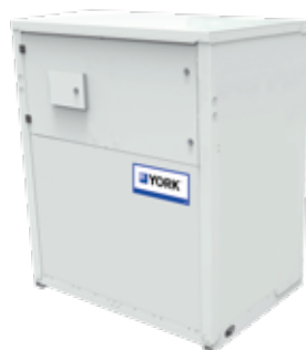
YWH Wasser-Wasser-WP Scroll Verdichter / R134a Warmwasser bis zu 78°C Heizleistung: 38 bis 301,2 kW
