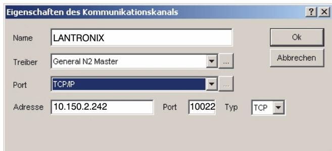
Abbildung 156: Lantronix Gerät wurde definiert
