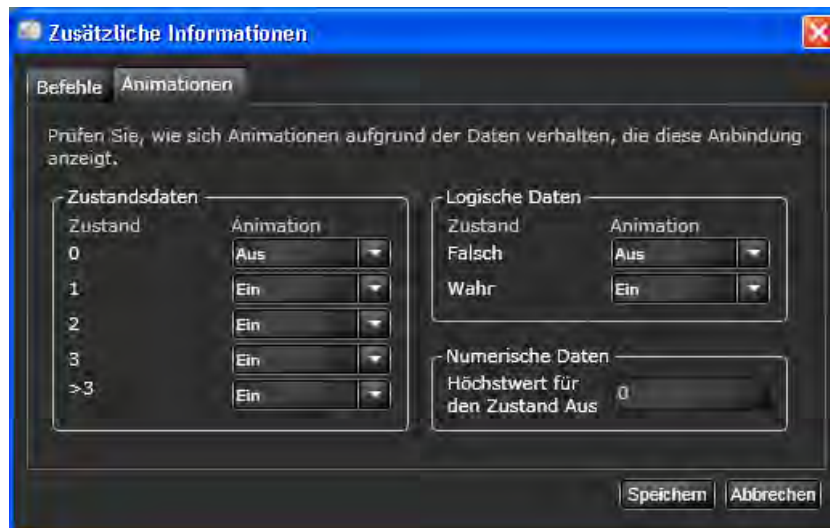
Abbildung 85: Beispiel für die Registerkarte Animationen (Abluftventilator)
