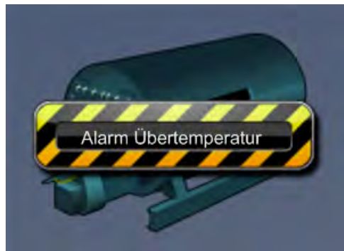
Abbildung 306: Beispiel einer Meldungsanzeige für einen Kessel
