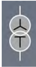
Abbildung 229: Transformator - Horizontale Orientierung
