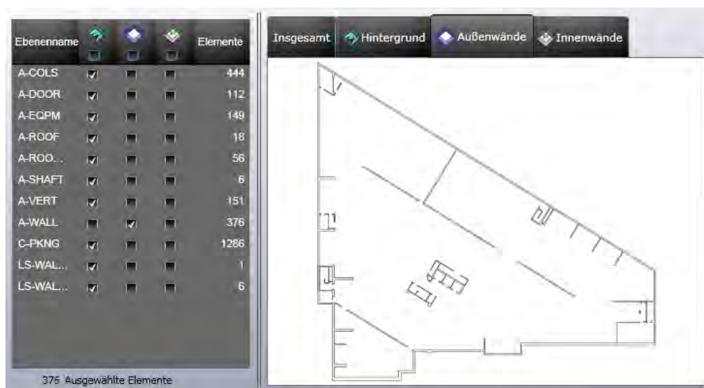
Abbildung 61: Auswahl der Außenwand-Ebenen
