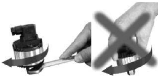
Abbildung 116: Sollwerteinstellung mittels Einstellschraube beim P215PR, P215RM, P315PR
